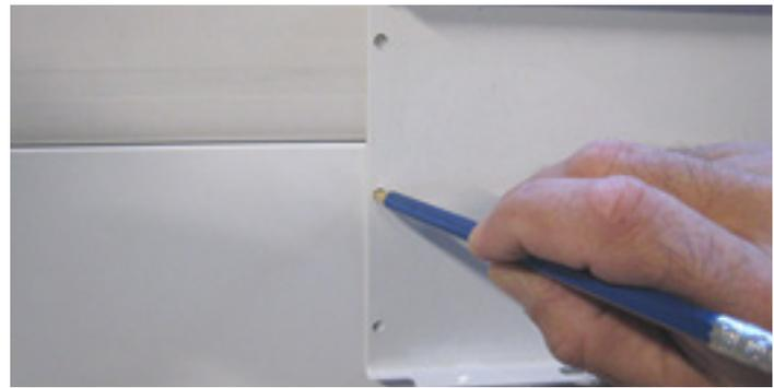
5.) Das mitgelieferte Metallplättchen mit der Klebefläche mittig auf der Kühlzellentür befestigen (So, das es bei geschlossener Tür unter den orangenen Sensor ragt.)
